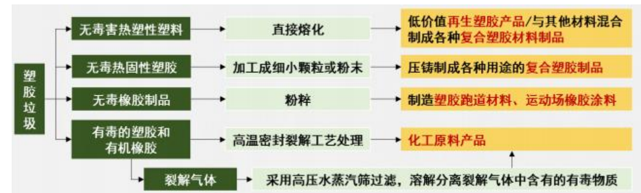
图 7-4 塑料垃圾资源化回收利用流程图
