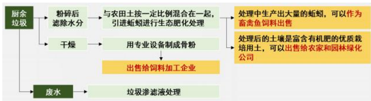
图 7-3 厨余垃圾资源化回收利用流程图
