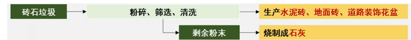
图 7-7 砖石垃圾资源化回收利用流程图
